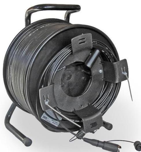
Полевой оптический кабель МОКС с бесконтактными соединителями типа МИНИ на основе технологии *Expanded Beam* (расширенного пучка света) предназначен для оперативной организации волоконно-оптических линий передачи в жестких условиях эксплуатации. Такие соединители обеспечивают быстрое и надежное подключение кабеля к аппаратуре контейнерного размещения и мобильным системам различного назначения.
